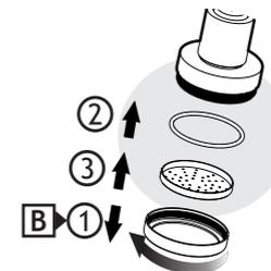
Desmonte conforme a sequência da ilustração para retirar o **Arejador**.
